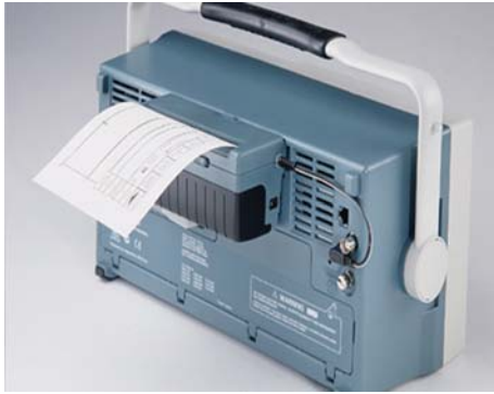
Рис. 5. Установка локального принтера на задней стенке осциллографа
