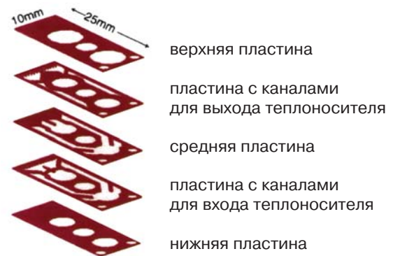
Рис 3, в. Структура теплоотвода лазерного диода
